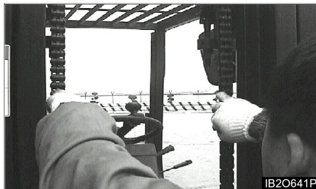
Exemplu reprezentativ pentru tensiunea egală a cadrului furcilor
